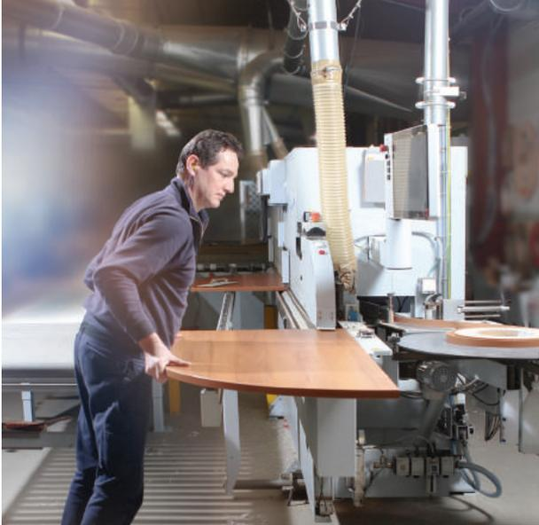
▲ Atelier menuiserie : pose des chants sur centre de placage à commande numérique de dernière conception avec technologie à air chaud.
